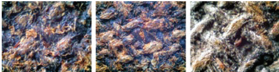
Vipavski Križ, cerkev Sv. križa, primerjava platna pred odstranjevanjem oljnega premaza (levo), po odstranjevanju premaza s skalpelom (na sredini) in po odstranjevanju premaza z mikropeskalnikom (desno) (foto: V. Klančar)
